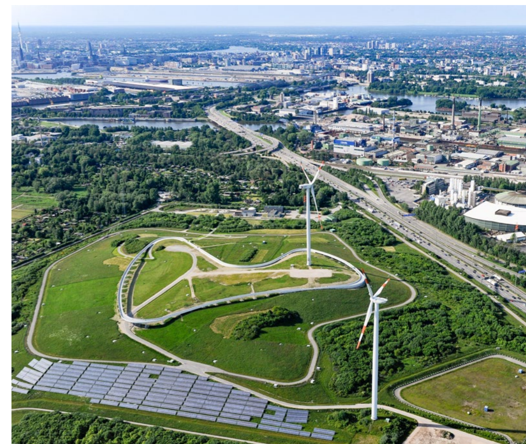
In Georgswerder ist aus einem Deponiehügel der Energieberg Georgswerder entstanden. Hier erzeugen wir mit Windkraft und Photovoltaik Ökostrom für rund 4.000 Hamburger Haushalte.
